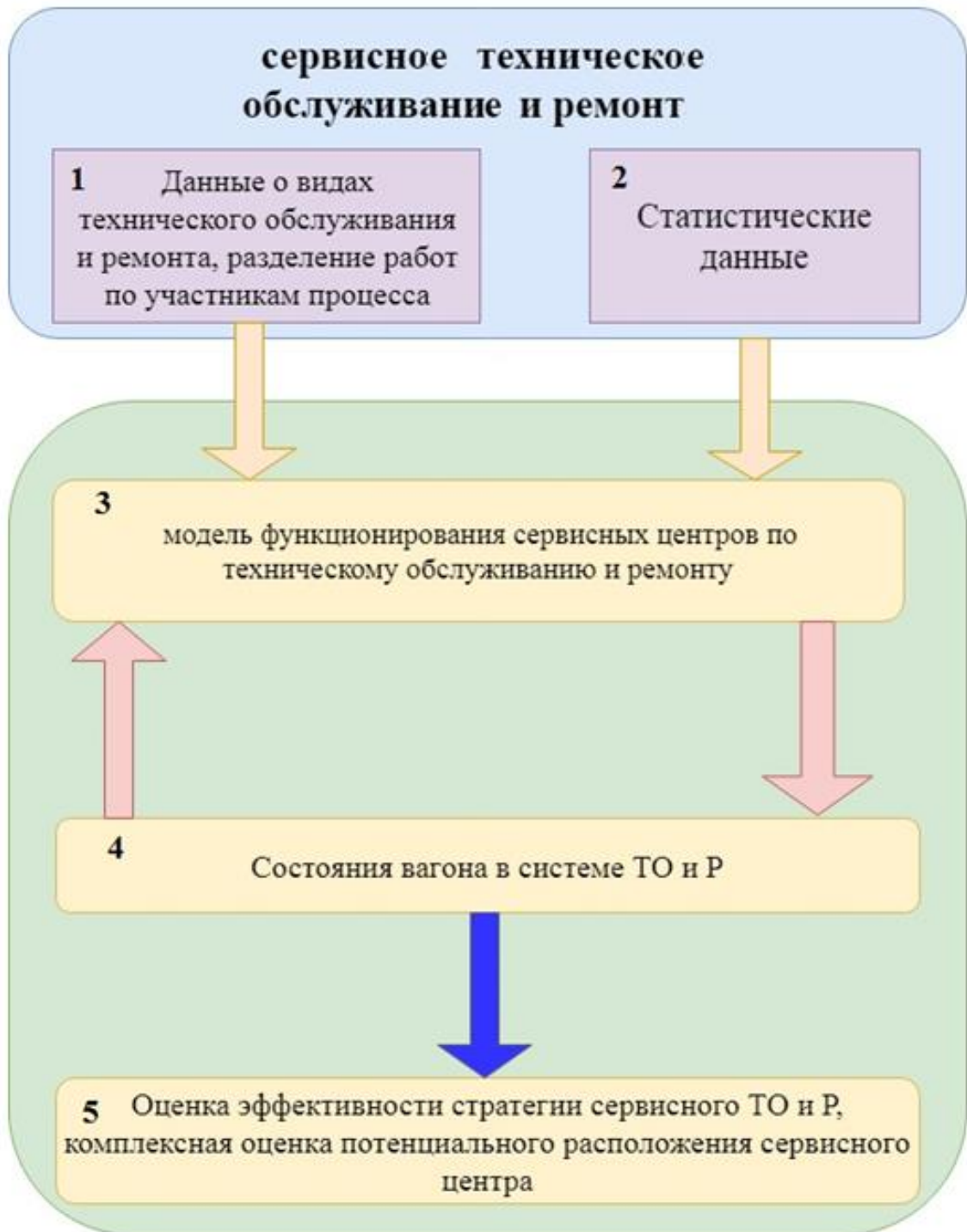
Рисунок 3.1– Структура сервисного технического обслуживания и ремонта пассажирского подвижного состава
