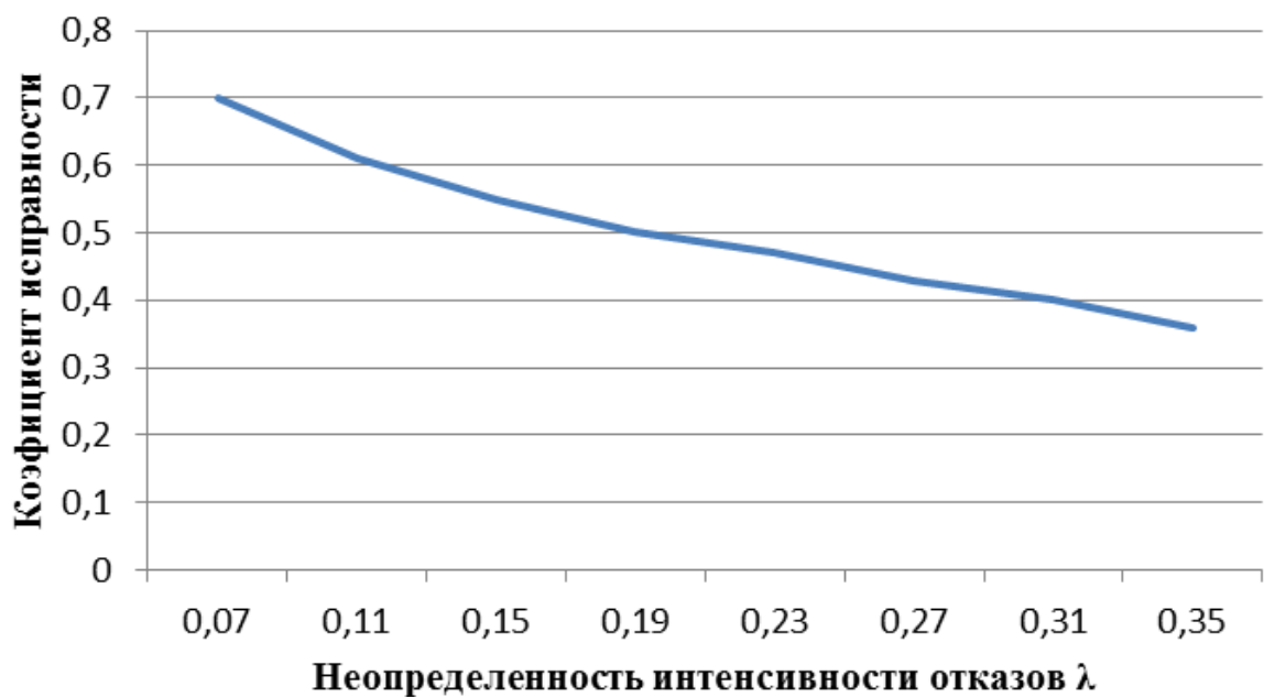
Рисунок 2.13 – Зависимость коэффициента исправности от величины интервала неопределенности интенсивности отказов
