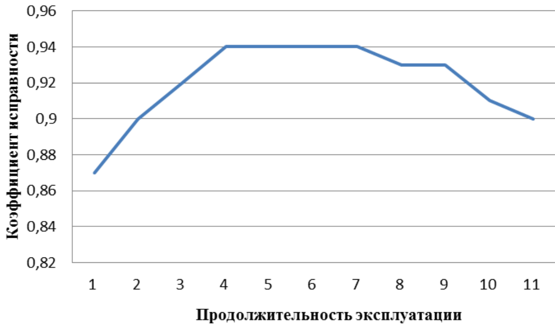
Рисунок 2.12 – Динамика исправности подвижного состава
